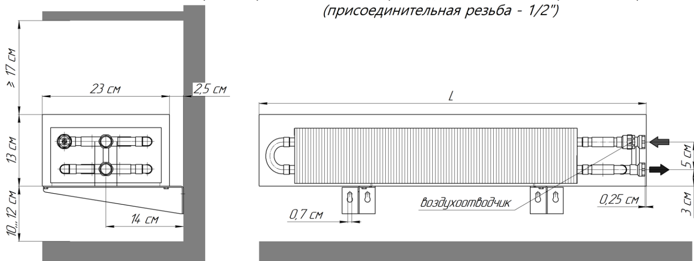
Настенный конвектор "Элегант - мини 230x130-4то Стен прав" с правосторонним нижним подключением (левостороннее - зеркально) (присоединительная резьба - 1/2")
